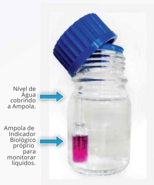
Figura 2 - Ampola dentro do frasco de vidro
