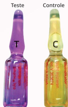
Fig. 3 - Ampola Teste e ampola Controle após incubação.
