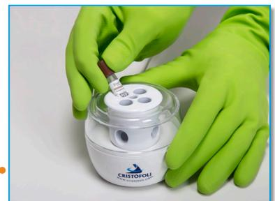
**7** Introduza 1/3 da ampola teste dentro da incubadora. Para ativá-la dobre a parte superior da ampola plástica, que é flexível. Isto resultará na quebra da ampola interna de vidro, liberando o meio de cultura para contato com os esporos. Cuidado para não romper a parte plástica.
