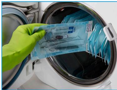
**3** Coloque um indicador em um envelope dentro da autoclave já abastecida com um ciclo padrão\*.
