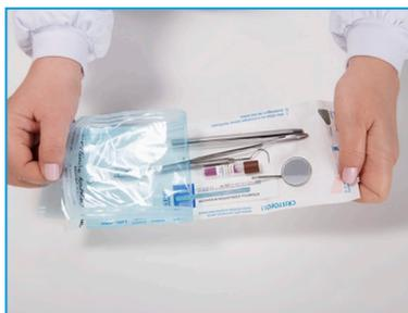
**6** Terminado o ciclo de esterilização, aguarde 15 minutos para o resfriamento. Abra o envelope e recupere a ampola teste autoclavada.
