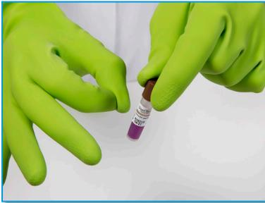
**8** Segure a ampola conforme demonstrado. Dê um peteleco na parte inferior de modo a somente deslocar esta região do tubo. Certifique-se de que o meio de cultura roxo embebeu totalmente o disco com esporos. A parte superior da ampola possui um filtro hidrofóbico (ver foto detalhada da ampola na página 2) que não deve ser molhado. Por esse motivo, não agite a ampola de cima para baixo.
